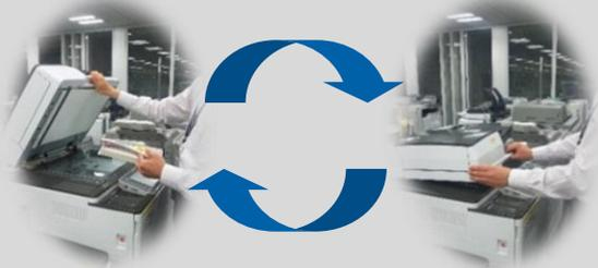
如果自动送稿器或盖板没有正确关闭，复印副本上会在图像边缘容易出现黑边和阴影。
